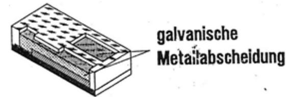
d) Aufbau einer metallischen Struktur
